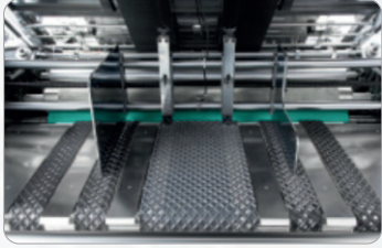
网格强力吸风系统 Suction system
