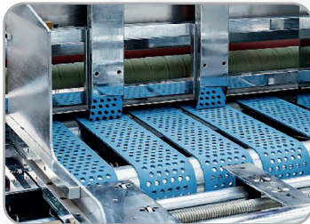
02. 底纸部分/Bottom Paper Feeding System
